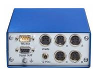
Auf der Rückseite des Gerätes befinden sich 4 Anschlüsse für Eluenten (Minimum-Grenzfüllstandssensoren) und 1 Anschluss für den Waste (Maximum-Grenzfüllstandssensor). Jede 5-polige Sensorbuchse trägt einen Erdungssowie einen Speisepin (12V).
